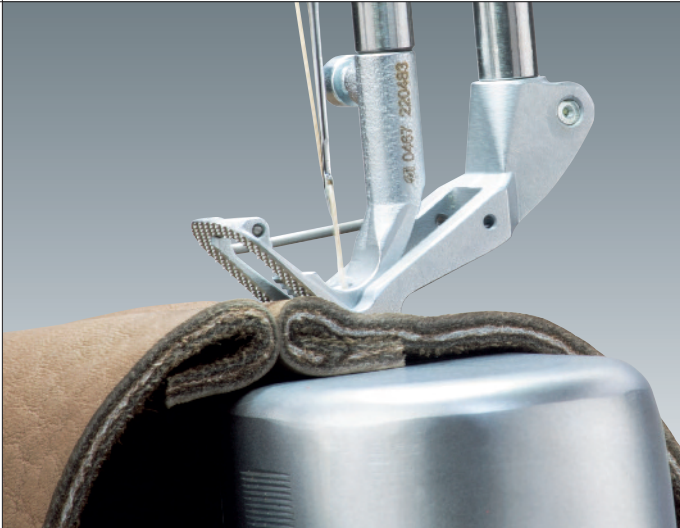
Nähergebnis ohne „MTD“ Sewing result without "MTD"
